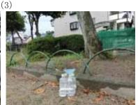
この3地点に降った雨(同じ時)を採取し雨5cm³に自分で作ったナスの指示薬2cm³を加え、自分で作った基準液の色と見比べて酸性度を決めて、比較する。
