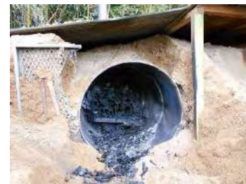
図8 ドラム缶窯で竹炭製作
