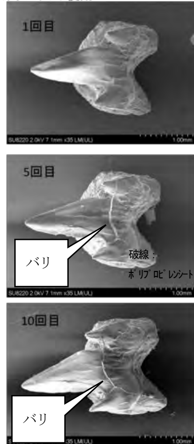
サメの歯化石レプリカ 1回目 5回目 10回目 ブルーミックスソフト使用
