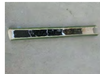
図9 竹利用型ろ過装置
